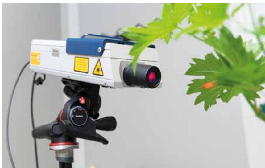
Set up sperimentali per lo studio della comunicazione vibrazionale degli insetti. Il laboratorio di biotremologia applicata con il laser Doppler vibrometro puntato sulla foglia di una pianta, uno strumento di precisione che permette di registrare i segnali vibrazionali. Un mini-shaker è posto in contatto con una foglia per riprodurre sulla pianta le vibrazioni
